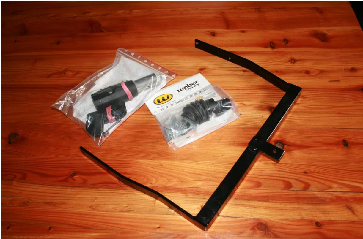
Segway Anhängervorrichtung mit Weber-Kupplung und Schloss für Deichsel
